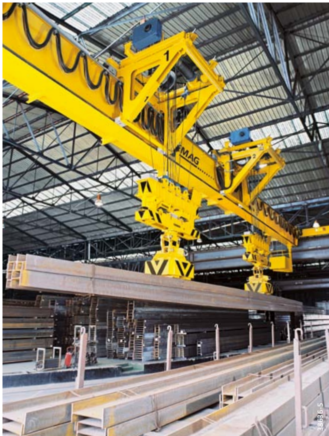
Synchronisation der Bewegungsabläufe zweier Hubwerke durch Master-Slave-Funktion
