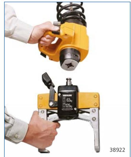
Sowohl Greifer als auch Zangen beruhen vielfach auf einem Scherenmechanismus. Insbesondere der Parallelgreifer PGS bietet, ausgestattet mit verschiedenen Greifbacken, zahlreiche Einsatzmöglichkeiten, z.B. als Wellen-, Systembehälter- oder Kistengreifer.
